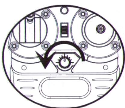
S'il tourne dans le sens des aiguilles d'une montre, tournez le compensateur vers la gauche.
