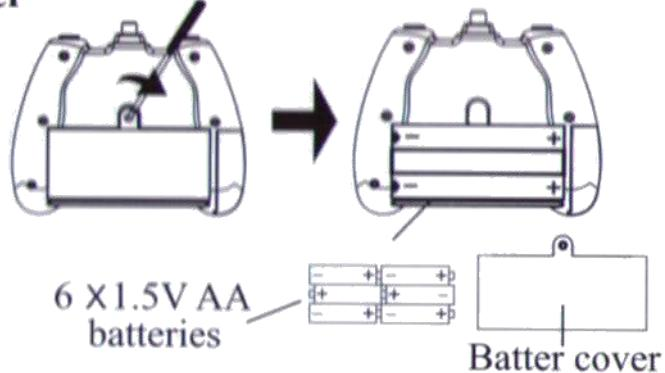
Ouvrez le cache et insérez les 6 piles AA en suivant les indications de polarité, puis fermez le cache.
