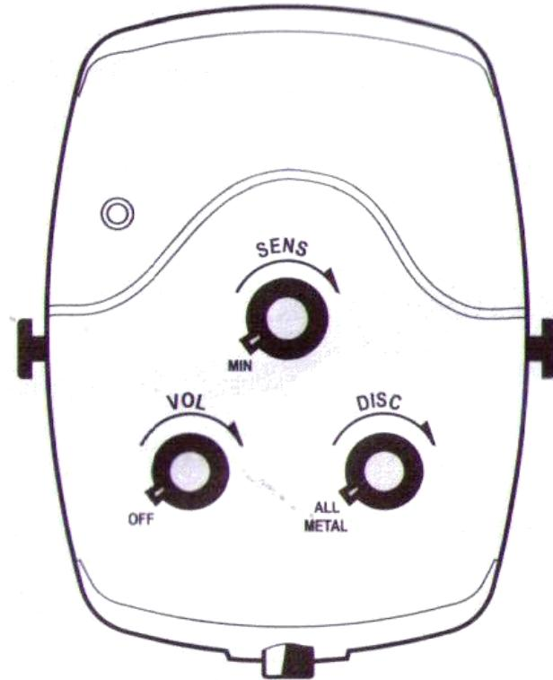
Volume : Ce bouton sert à allumer/éteindre l'appareil. Il suffit de le tourner vers la droite pour allumer le détecteur. C'est le même bouton qui sert à la fois pour allumer l'appareil et pour régler le volume du son.
