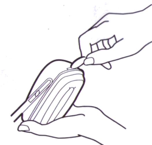
Insérez la pile dans le compartiment en suivant les indications de polarité marquées dans le compartiment. Refermez le compartiment, vous devez entendre un « POP ». Remettez la cache du compartiment. Si vous n'utilisez pas l'appareil pendant une semaine ou plus, retirez la pile.
