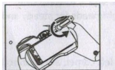
de la batterie en desserrant le couvercle avec un tournevis.
