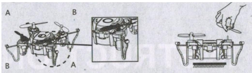
▲▲ Installation : Tenez la tête pour viser l'axe du moteur et appuyez pour le verrouiller. Veillez à ne pas endommager ou déformer les lames.
