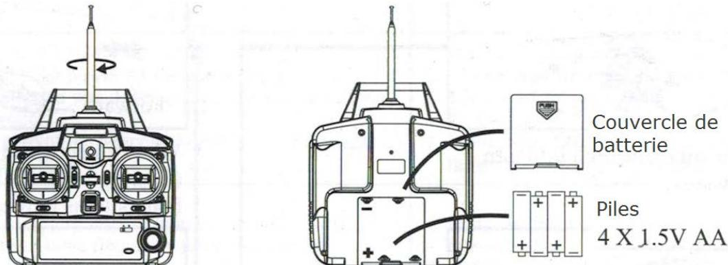
1. Installation de l'antenne: installer l'antenne dans la télécommande en tournant dans le sens des aiguilles d'une montre jusqu'à blocage.
